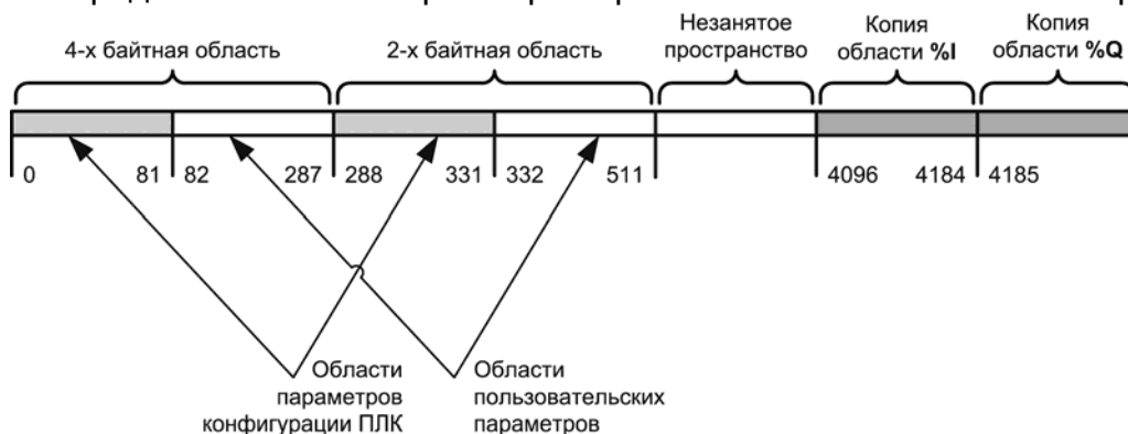
Рисунок 7.27 – Распределение области регистров протокола Modbus при работе ПЛК в режиме Slave-устройства.
